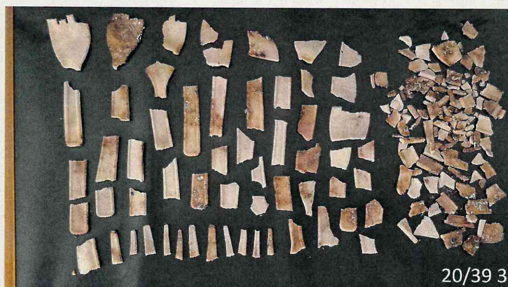
8. ábra: Visszamért biopolimer minták 28 nap üzemi komposztálás után
