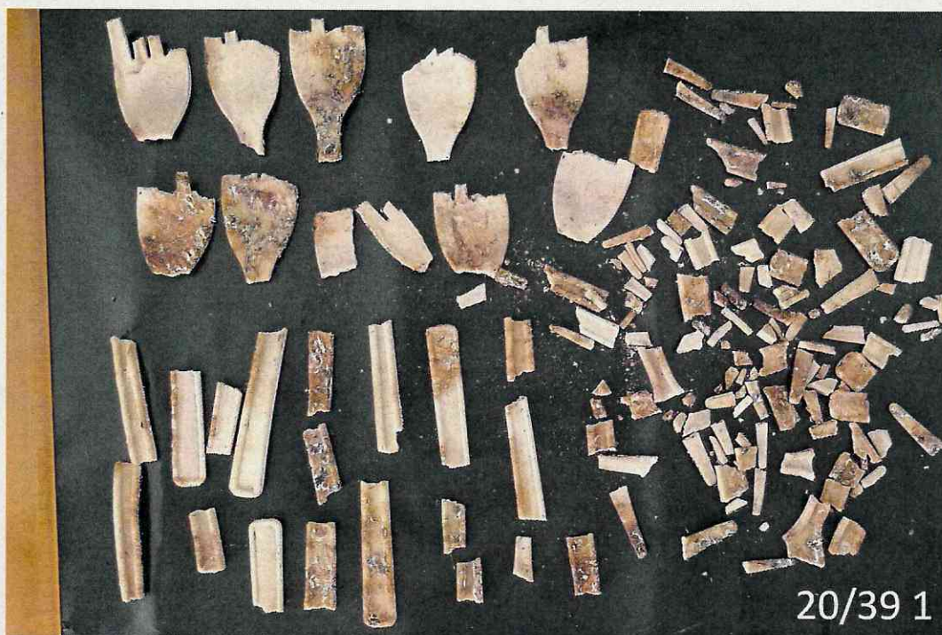
4. ábra: Visszamért biopolimer minták 28 nap üzemi komposztálás után
