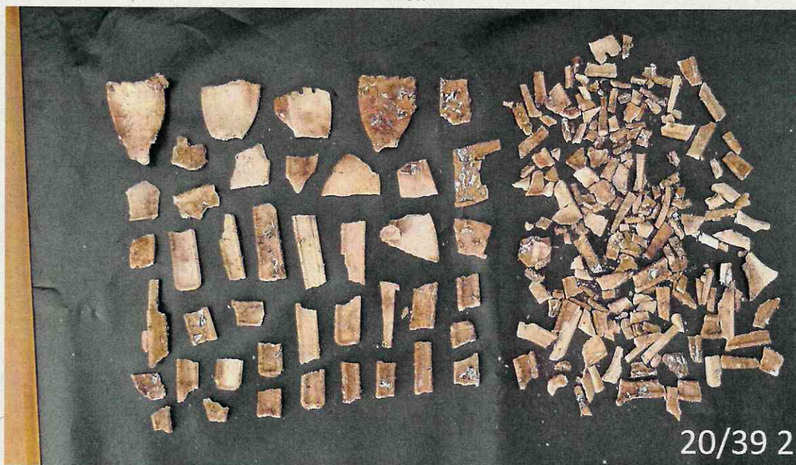
6. ábra: Visszamért biopolimer minták 28 nap üzemi komposztálás után
