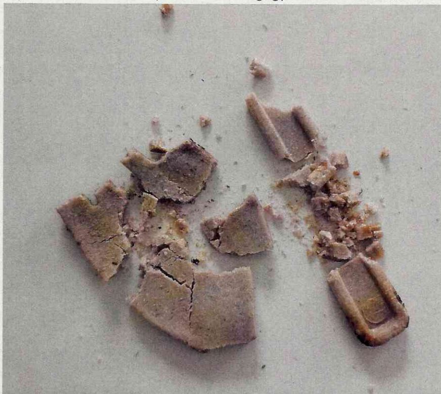
12. ábra: A visszanyert minta érintésre nem véges számú darabra morzszálódik
